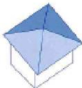
●方形(ほうぎょう)屋根 4方を均等として四方に傾斜する4つの面で構成する四角形の屋根。
