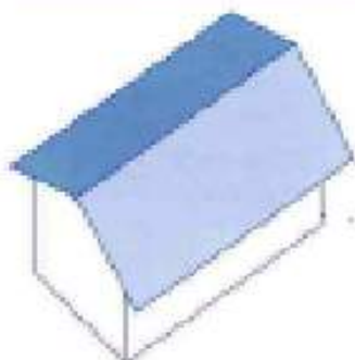
●切妻(きりづま)屋根 2方向の傾斜がシンプルな屋根で、我が国で最も代表的な屋根。
