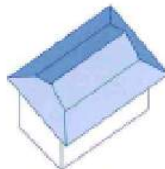
●入母屋(いりおもや)屋根 上部が「切妻屋根」、下部が「寄棟屋根」のようになっている屋根。
