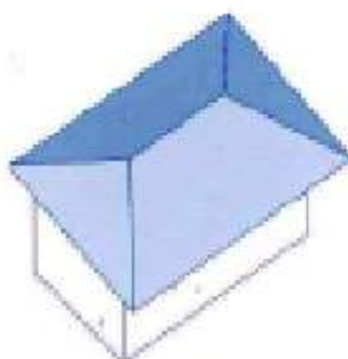
●寄棟(よせむね)屋根 4方向の傾斜で構成される屋根。端正な外観。
